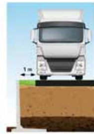
DLF10GSZ gelijkmatig verdeelde overlast 40 kN/m² op randafstand 1 m equivalent aan belastingsmodel LM1 volgens NBN EN 1991-2
