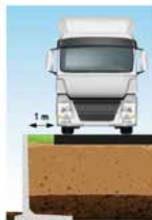
DLF10GSZ charges standard 40 kN/m 2 à une distance de 1 m du bord équivalent du case de charge LM1 selon NBN EN 1991-2
