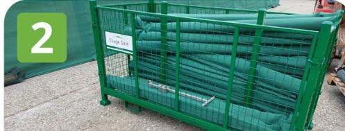
In der Gitterbox werden Bahnen mit Zugösen von Bahnen mit Riemen getrennt.
